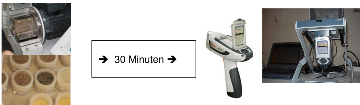
Abb. 2: Zerkleinerung EBS und Analyse mittels tragbarem oder stationär betriebenen RFA-Gerät
