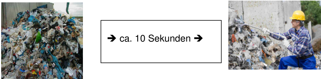
Abb. 3: Einsatz tragbare RFA zur Risikobewertung an grobstückigem Frachtträgern
